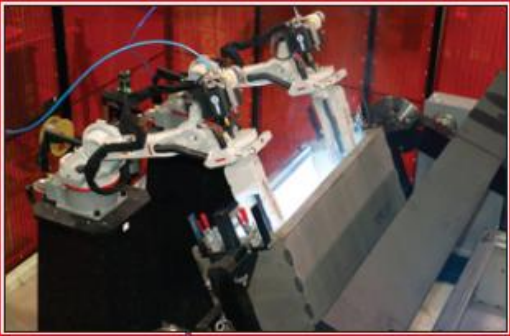
深入狭窄腔体内部焊接
