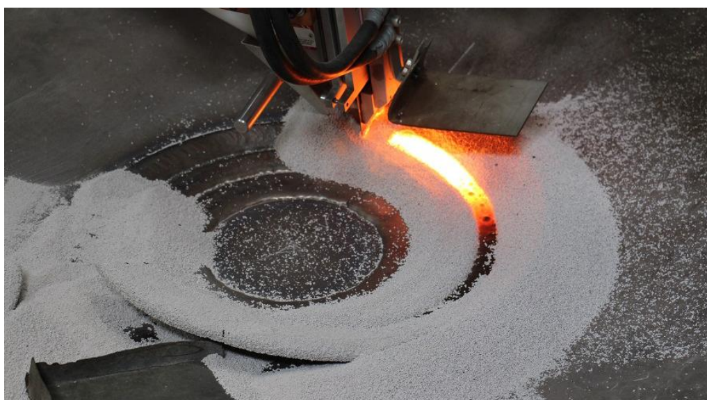
图 2：时代带极堆焊实际效果
