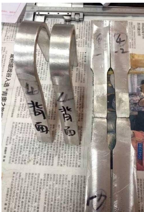
图4 弯曲、拉伸试样
