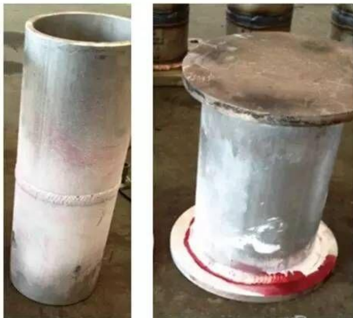
图 3 对接、角接焊缝探伤合格
