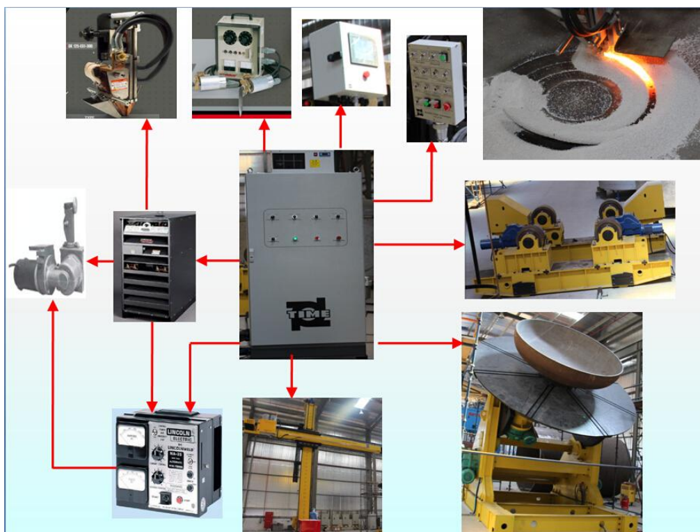
图 3：带极堆焊的组成
