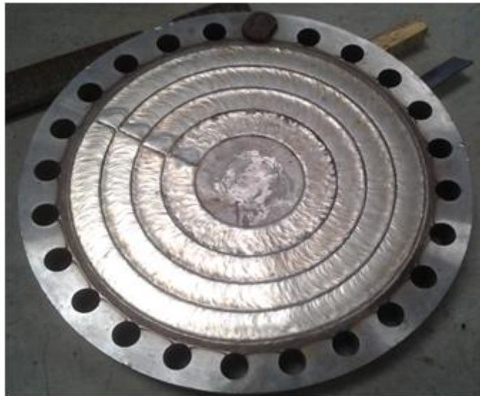
图 1：堆焊基体材料、层材料
