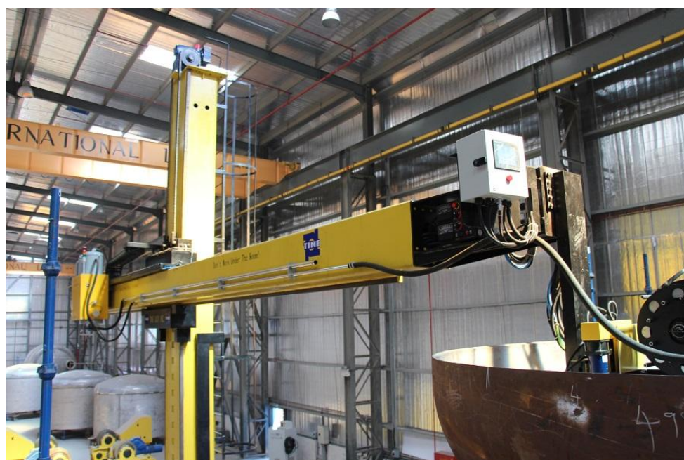
图 5：时代带极堆焊中央控制器现场应用
