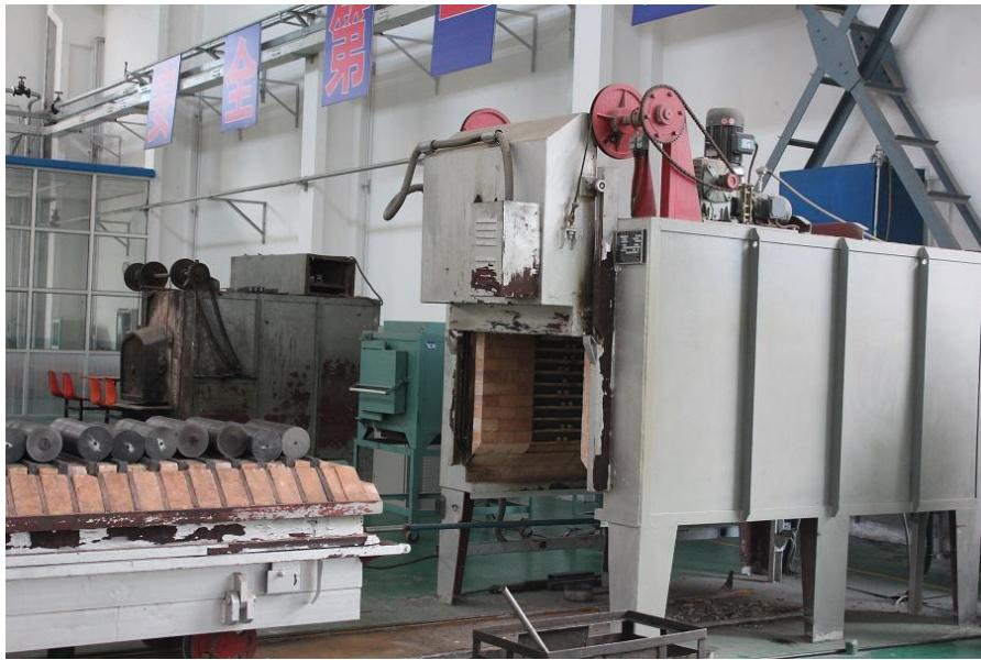
焊后热处理指将焊件整体或局部加热保温，然后炉冷或空冷的一种热处理方法。其目的是消氢、消除焊接应力、改善焊缝组织和综合性能。
