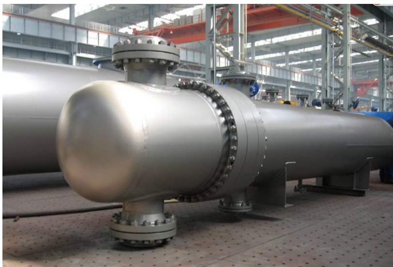
图 1：不锈钢压力容器
