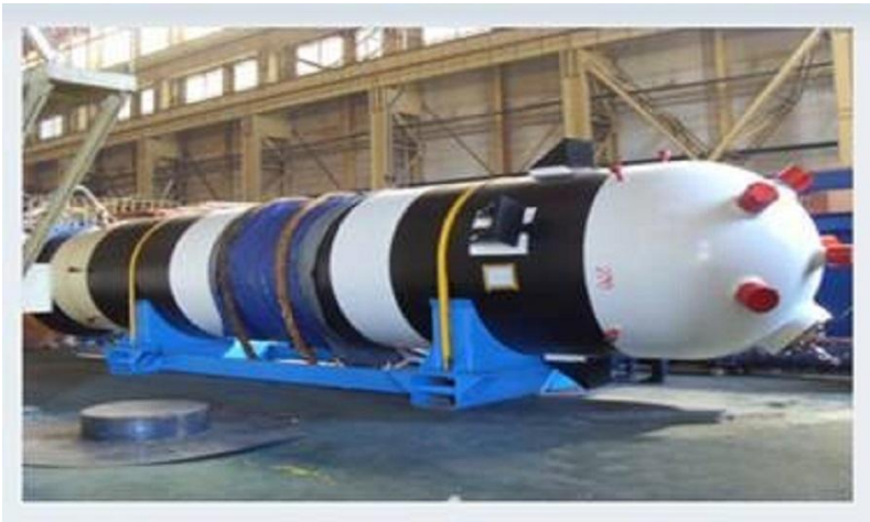
图 1：核电稳压器容器
