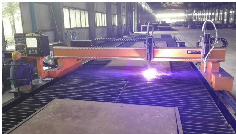
图 1：数控切割机配置及现场应用
